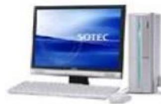
Un'aliquota molto importante dei videoterminali è rappresentata dai Personal Computer (PC), ovvero, una macchina per l'elaborazione di dati progettata per l'uso da parte di una sola persona per volta (in opposizione per esempio ai mainframe, a cui interi gruppi di persone accedono contemporaneamente attraverso terminali remoti).
